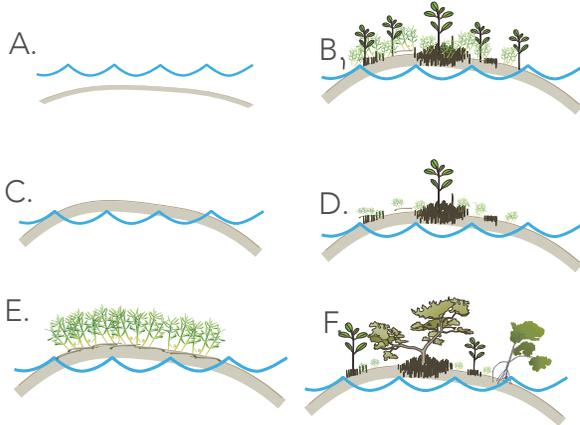
Para la elevación de la topografía, se recomienda que el suelo que se retiró de los canales secundarios, se acomode en el centro de un círculo de 2.5 m de radio y 0.4 m de altura. Después se extiende y aplana, formando una terraza más elevada con respecto al suelo en el lugar. Deberá separarse cada centro del círculo, al menos 10 m uno del otro; y se construirán canaletas. Con esta técnica se garantizará la circulación constante del agua, permitiendo el transporte de propágulos
