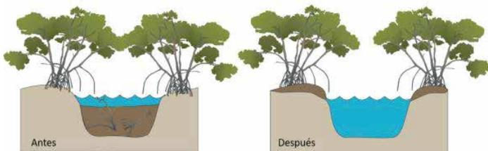
Figura 24. Fotografías del proceso de desazolvamiento de un canal principal.
