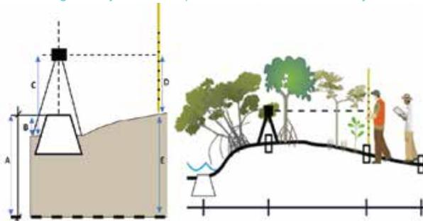
**C. Nivelación con estación total:** La estación total se planta sobre el suelo, por encima de la mojonera; y debe haber una línea de vista a otra mojonera, para usarla como referencia auxiliar. Ambas coordenadas conocidas se introducen al instrumento. Después un segundo operario, con ayuda de un prisma reflejante y un bastón de aplomar, se coloca en la mojonera de referencia auxiliar; y se realiza
