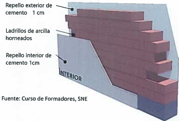
Fig. 3 Detalle de Pared Mostrando Repello y Ladrillo Interior
