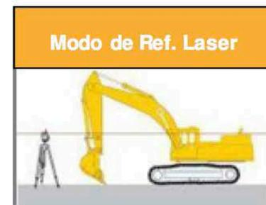
**Sensores de ángulos y pantalla en cabina guían al operador:**
