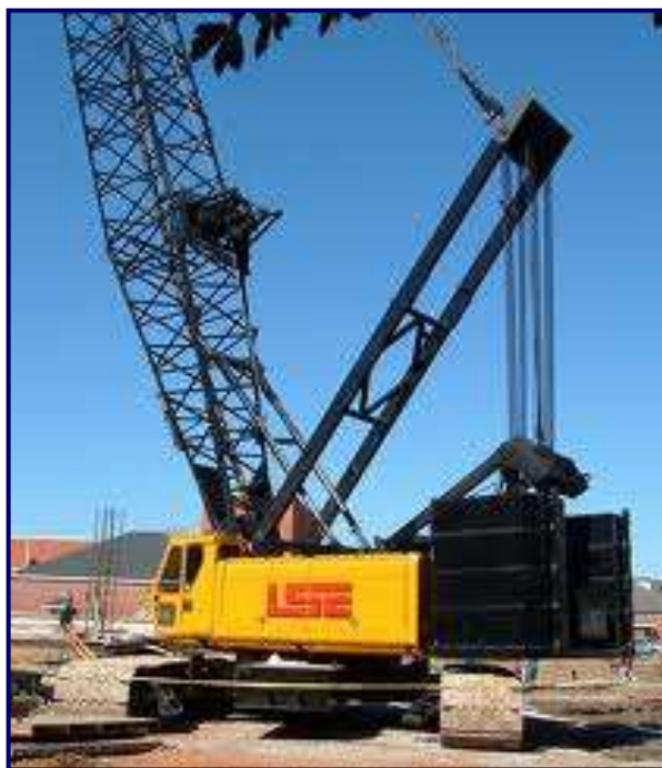
Grúa de Cerchas sobre Orugas Terreno
