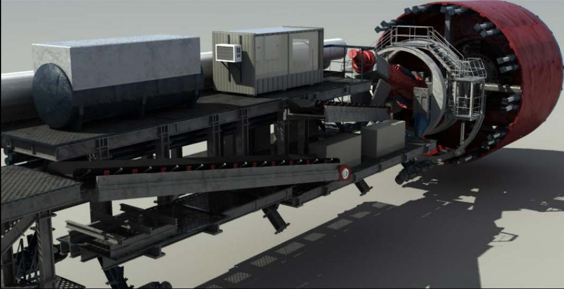
Se emplean dos tuneladoras tipo EPB diseñadas para esta combinación de terrenos.
