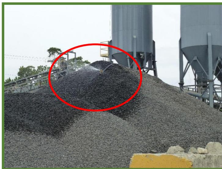
3. Mantener el suelo descubierto humedecido durante la temporada seca. Para ello se puede armar un sistema vehicular de riego de agua en el vagón de un camión mediano; puede resultar más económico que un camión cisterna.
