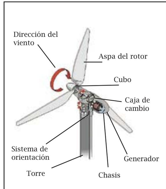
Figura 5. Componentes de una turbina eólica
