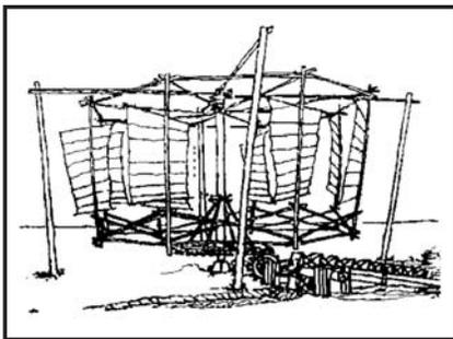
Figura 1. Molino de eje vertical tipo chino.
