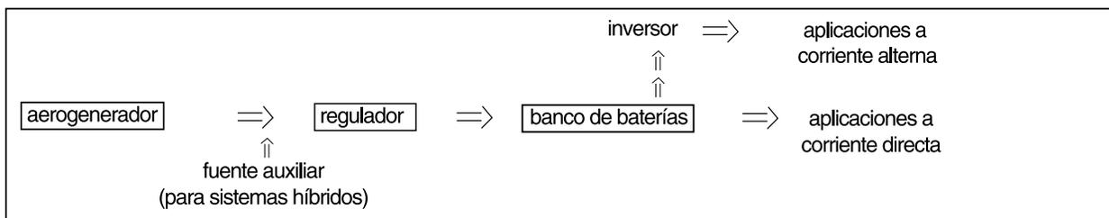
Figura 8. Esquema de un sistema eólico aislado
