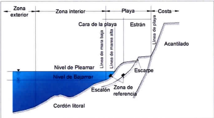
Ilustración 2. perfil de playa y definición de terminología. fuente (Ocaña, 2015).
