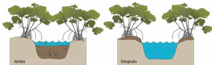
Figura 23. Esquema que representa el canal primario, antes y después de la restauración. En la imagen se observa el canal antes de las acciones, con sedimento y ramas de árboles obstruyendo el paso de agua. Luego de realizar el desazolve (limpieza), el canal queda libre y permite una mejor conexión entre los cuerpos de agua. Símbolos cortesía de la integración y la red de aplicaciones.
