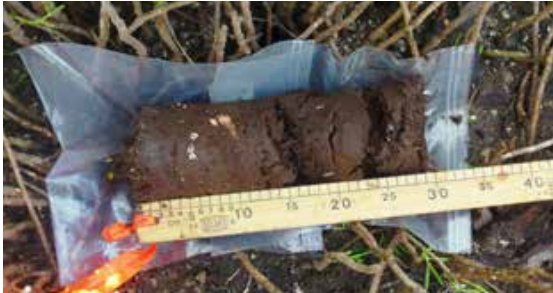
Figura 17. Monitoreo de características del suelo: Obtención de núcleo de sedimento para su posterior análisis.
